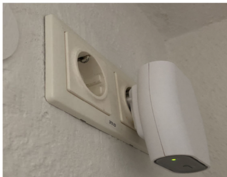
Abbildung 4: LoRA Gateway montiert (Bildquelle: HK)
